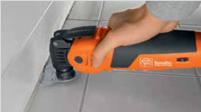
Elastisten saumatiivistysaineiden poistamiseen.
