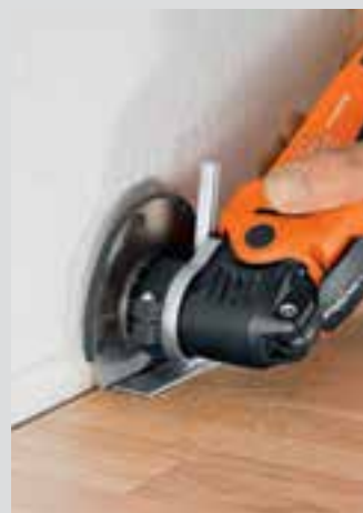
Tarkkaa työskentelyä reunan lähellä myös syvyysrajoitinta käytettäessä.
