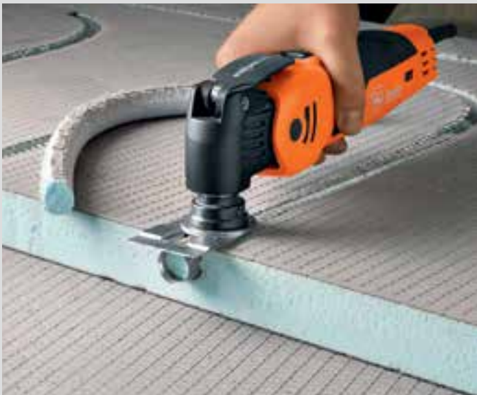
Lattialämmityksen lämminvesikanavien leikkaamiseen.
