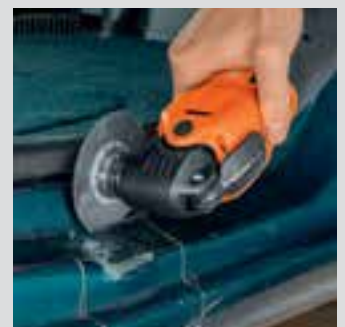
Sahaus ilman vääntymää, siisti leikkau jälki, ohut leikkauslinja ovat eduksi korikorjauksessa.
