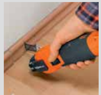
Työstettävän kappaleen takana ei tarvita vapaata tilaa.
