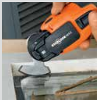
Kitattujen eristyslasien irrottamiseen.
