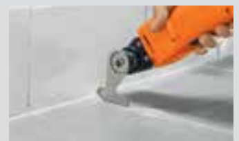
Timanttisegmenttiterä kulmien alueilla tehtäviin leikkauksiin.
